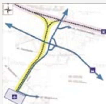
Schienenverbindung zwischen der Linie E-30 und dem neuen Terminal des Flughafens Breslau
